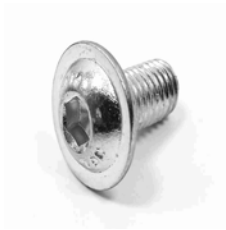
Śruba Imbusowa Grzybk.Kołn. M5x16 ISO 7380-2 Kl. 10.9 ocynk
