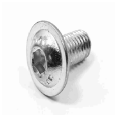
Śruba Imbusowa Grzybk.Kołn. M5x20 ISO 7380-2 Kl. 10.9 ocynk
