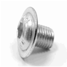
Śruba Imbusowa Grzybk.Kołn. M8x16 ISO 7380-2 Kl. 10.9 ocynk
